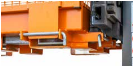
Einfahrtaschen an den nicht verwendeten Einfahrtaschen Sicherungsbolzen schützen vor unbeabsichtigtem Abrutschen
